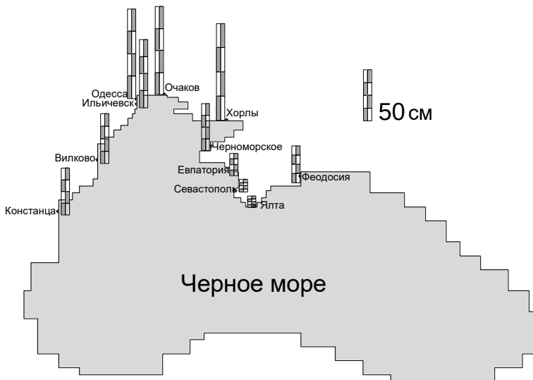
Рис. 2.11. Максимумы отклонений уровня, вызываемых движущимися циклонами на побережье Черного моря
