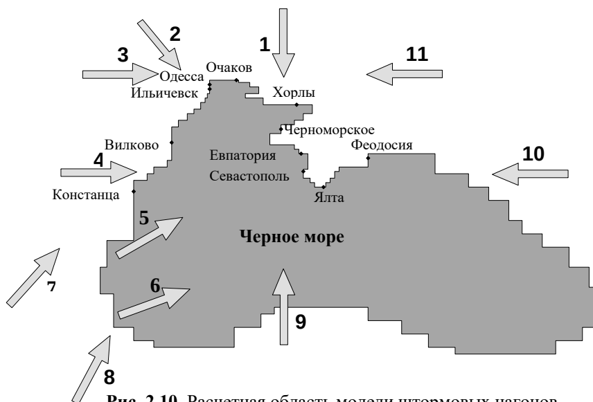
Рис. 2.10. Расчетная область модели штормовых нагонов в Черном море. Стрелками показаны направления перемещения центров модельных циклонов
