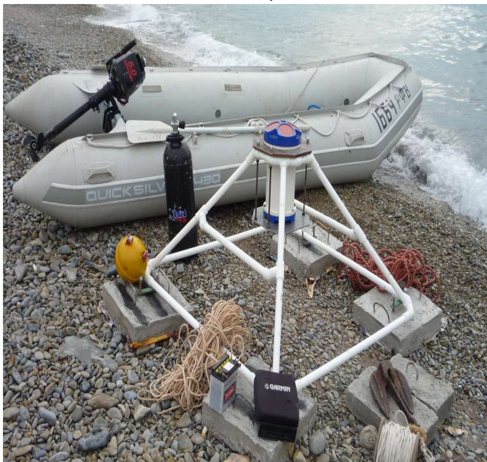
Акустический доплеровский профилограф скорости течения (ADCP) в пластиковой пирамиде
