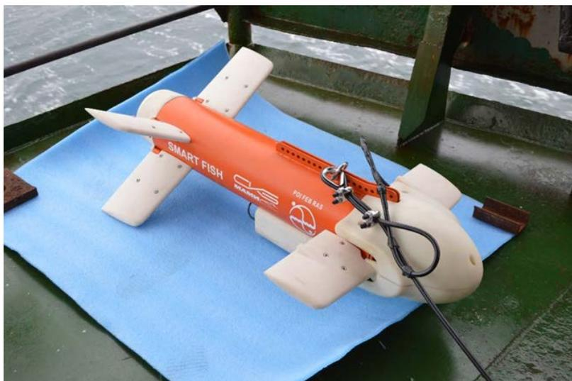
**Рис. 1.** Подводный измерительный комплекс Smart Fish на палубе НИС «Академик Опарин» перед спуском в водную толщу Чаунской губы
