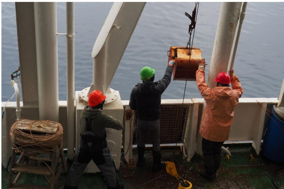
**Рис. 2.** Отбор проб при помощи дночерпателя
