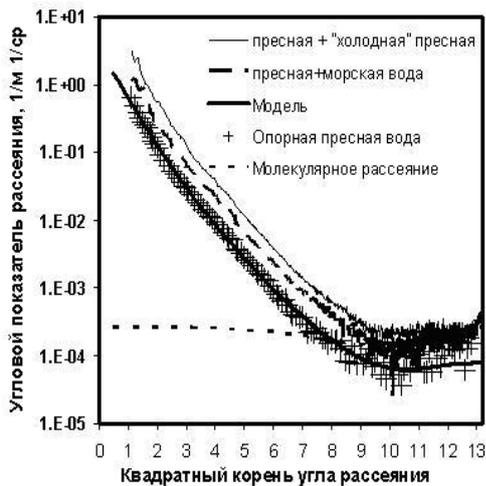
Рисунок 4 – Изменчивость углового показателя рассеяния в чистой пресной воде на 490 нм при добавлении 0,5% примесной жидкости
