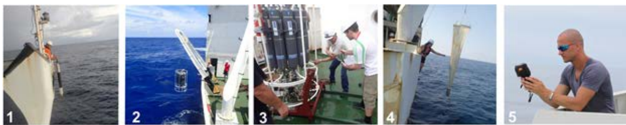
Рисунок 2. Мультидисциплинарные исследования в 42-м рейсе НИС «Академик Борис Петров»: 1 – геофизическая съемка с магнитометром MPMG-4; 2 – гидрологические измерения: зонд SBE 911plus с акустическим профилографом течений DVS-750; 3 – гидрохимические исследования водной толщи: отбор проб воды батометрами Нискина (Rozetta); 4 – сбор биологического материала с помощью планктонной сети; 5 – дистанционное измерение температуры поверхности океана инфракрасным термометром Testo 870-2
