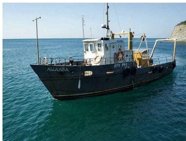
Рисунок 1. МНИС БПМ-74М «Ашамба». Водоизмещение – 27 тн, двухбарабанная лебедка, кормовая П-рама, стрела, два члена экипажа и шесть научных сотрудников
