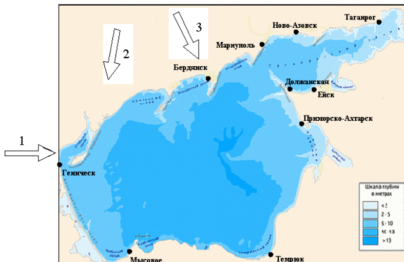
Рисунок 5 – Расчетная область численной модели и рассмотренные в работе направления смещения циклонов
